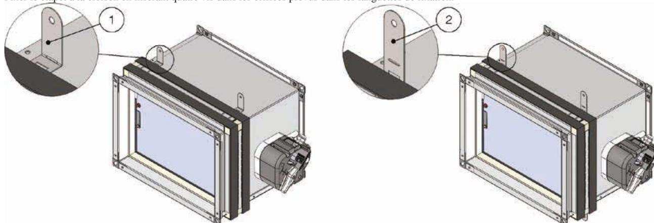
1. Pli pour cloisons d'une épaisseur supérieure ou égale à 100 mm
