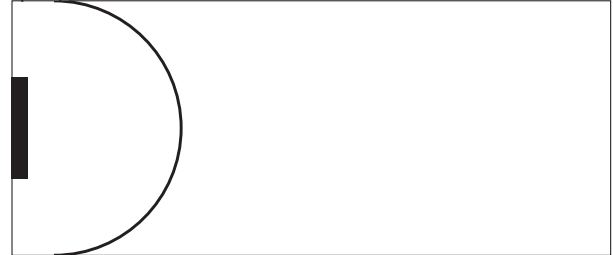
Figure 21, Un trop grand débit à travers un diffuseur entraîne une zone d'influence trop importante.
